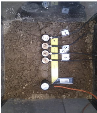
Cuves acoustiques fonctionnant aux fréquences audibles pour l'imagerie de milieux biophysiques (racines) ou géophysique (Benjamin MARY Thèse 2015)
