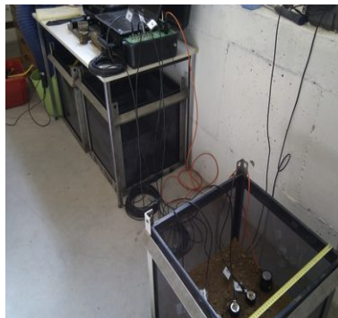
Cuves acoustiques fonctionnant aux fréquences audibles pour l'imagerie de milieux biophysiques (racines) ou géophysique (Benjamin MARY Thèse 2015)
