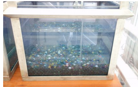
Etude acoustique de la diffusion multiple en milieux granulaires. Cuve acoustique fonctionnant aux fréquences ultrasonores.
